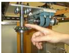
Fig.4 歯車部の露出状態
